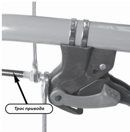
Со временем тросы привода могут растянуться. Для их регулировки необходимо расконтрить гайку и добиться оптимального натяжения тросов. Оптимальной регулировкой троса является начало движения культиватора при на- жатом рычаге сцепления на  $\frac{1}{3}$ .
