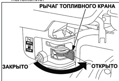
Рис. 9 Топливный кран карбюратора
